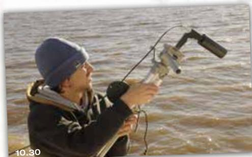
10.58. Muestra de agua y medición fotométrica para calcular la concentración de aerosoles, ozono, dióxido de carbono en la atmósfera. El clima a bordo es de un equipo a pleno. Todos hacen todo.
