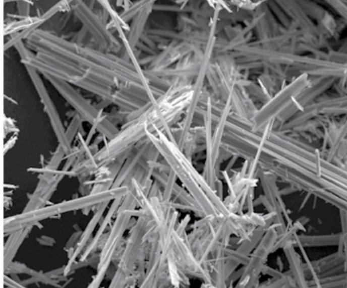
Fibras de amianto vistas con un microscopio electrónico.
