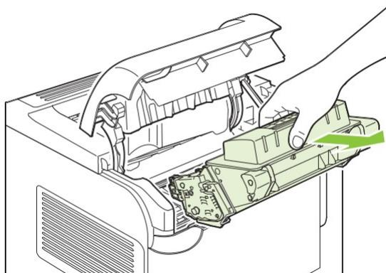
Extraiga el cartucho nuevo de la bolsa. Coloque el cartucho usado en la bolsa para reciclarlo.
