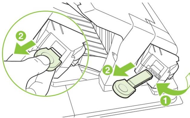
Inserte el nuevo cartucho de grapas en la grapadora y gírela hacia la parte posterior del producto impresora hasta que la grapadora encaje en su posición.
