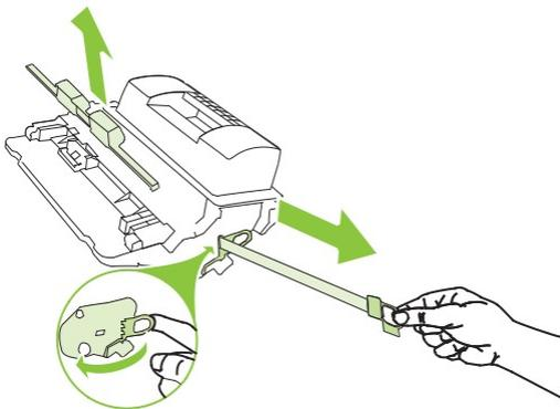
Alinee el cartucho de impresión con los rastros dentro del producto, inserte el cartucho de impresión hasta que se fije firmemente y, a continuación, cierre la cubierta superior.
